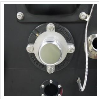
부품명 : 전면판 드럼베어링 모델 : UCSFC-208 교환주기 : 2년 부품명 : 전면판 드럼센서 모델 : Ø2.3 X 30L X 1/8" 교환주기 : 2~3년 부품명 : 후면 열풍센서 모델 : Ø1.6 X 30L X 1/8" 교환주기 : 2~3년
