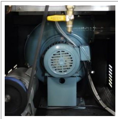
부품명 : 냉각브로워 모델 : 0.7kw 2P 교환주기 : 4년 부품명 : 드럼후면 베어링 모델 : UCSFC-210 교환주기 : 2년
