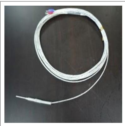
부품명 : 드럼 온도 센서 (품온 센서) 규격 : Ø2.3 - 20mm 교환주기 : 2~3년
